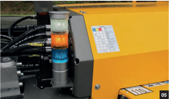
03 クランプ装置タイプ L 04 マノメータボックス 05 運転モード用シグナルライト EN 16228 06 無線リモコン
